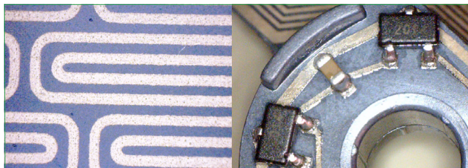
Abb. a: Mikroskopaufnahme der Zinnoberfläche von MID-Leiterzügen. b: Ausbildung der Lötstellen an Chipbauteilen (Oberfläche: Vectra 840i, chem. Zinn) Quelle: HARTING AG
